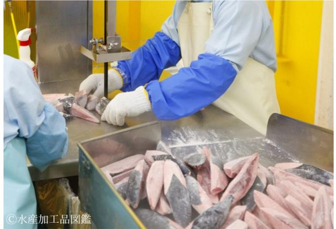
写真4 冷凍原料のバンドソーによる整形
