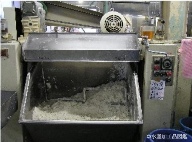
写真2 練り上げ・生地製造工程
