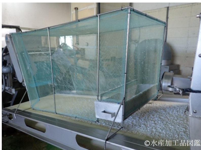
写真5 軽いカニの幼生などの選別・除去（提供：横田水産）
