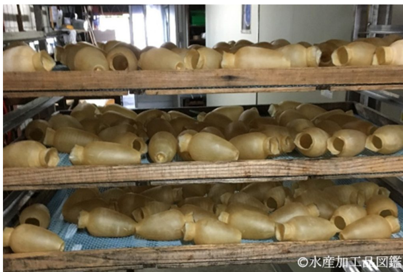
写真4 底成形後の仕上げ乾燥（提供：宮津市）
