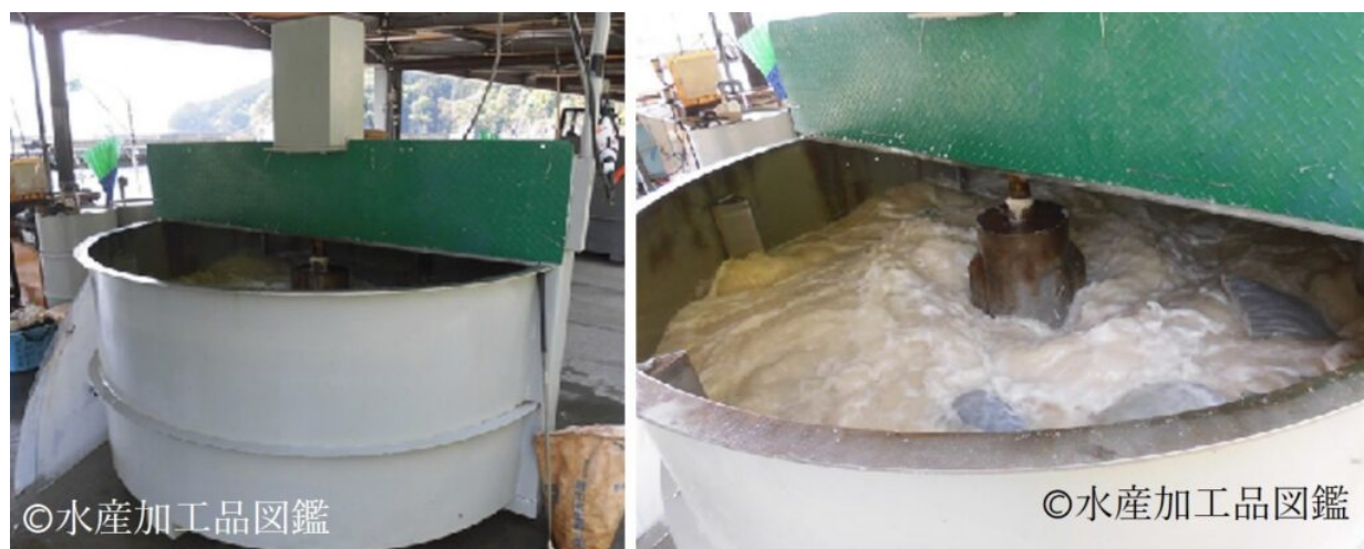
写真16 高速攪拌塩漬装置（しおまる）及び海藻の塩漬中の様子 （提供：岩手県水産技術センター）
