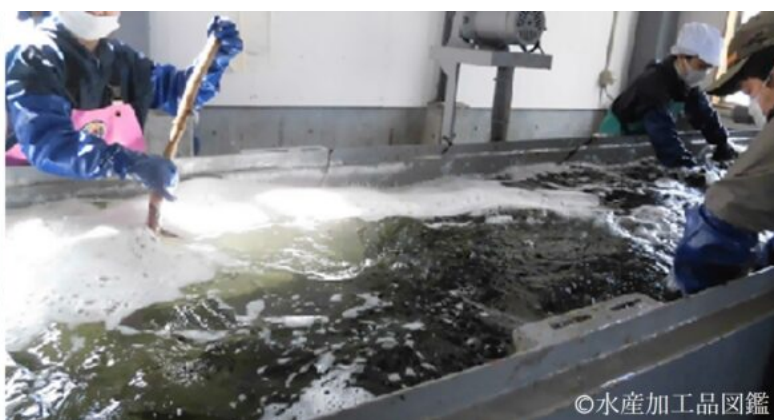
写真8 湯通しワカメの冷却工程（左：自家加工、右：民間加工場） （提供 左：岩手県水産技術センター、右：有限会社リアス海藻店）
