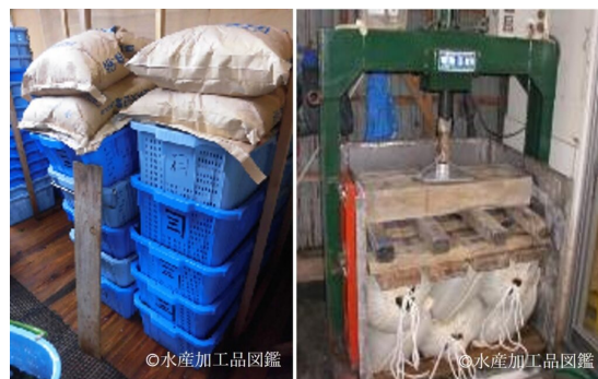
写真13 塩漬後のワカメの脱水 (左：重石式、右：水抜き式) (提供：岩手県水産技術センター)
