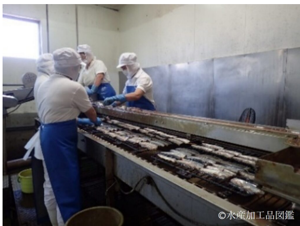
写真4 焙焼 焙網整列（提供：㈱田原缶詰）
