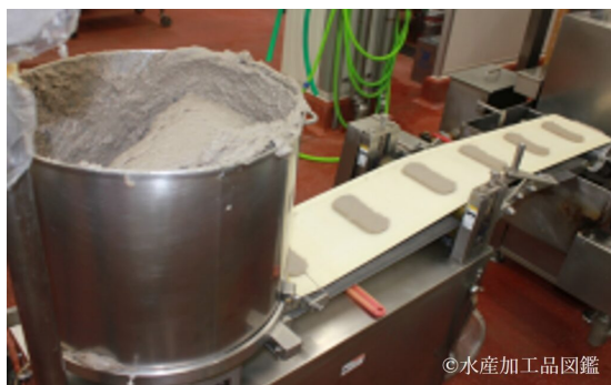
写真7 成形（成形機） （提供：(有)安岡蒲鉾）
