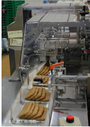
写真9 包装（包装機） （提供：(有)安岡蒲鉾）
