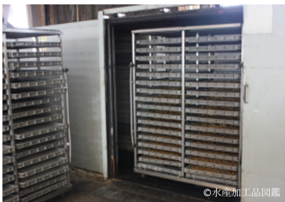
写真7 乾燥工程（温風乾燥機） （提供：（株）龍宮堂）
