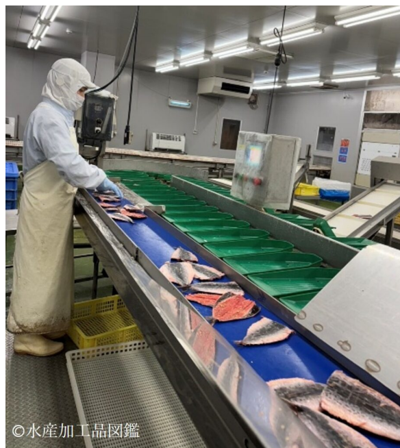
写真6 製造風景4（重量選別機投入） （提供：株式会社鴨安商店）
