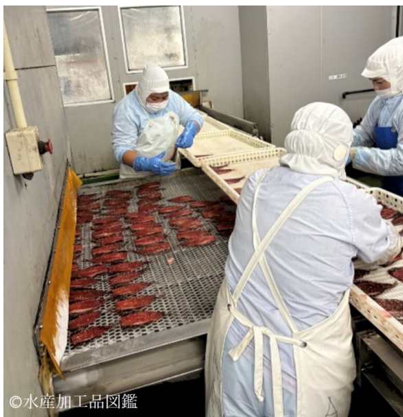
写真7 製造風景5（トンネルフリーザー投入） （提供：株式会社鴨安商店）
