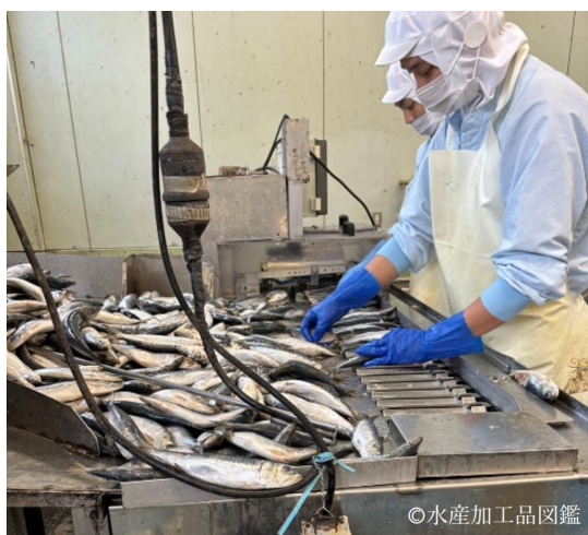
写真3 製造風景1（ヘッドカッター投入） （提供：株式会社鴨安商店）
