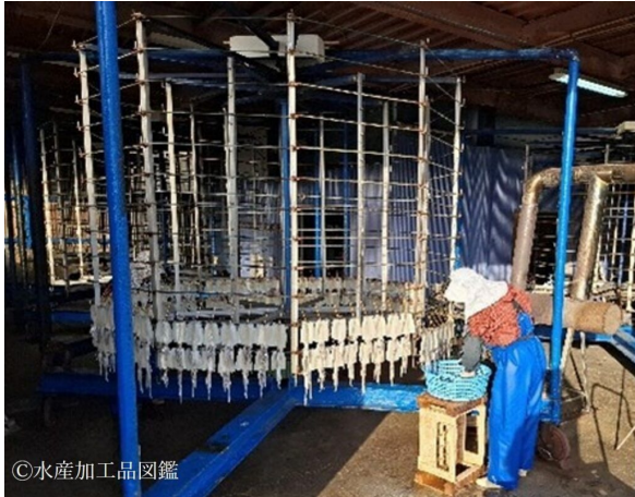
写真10 回転式乾燥機「カワキャンセ」 (提供：長崎県)
