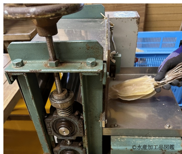
写真9 ロール機で伸展・整形している様子 (提供：長崎県)
