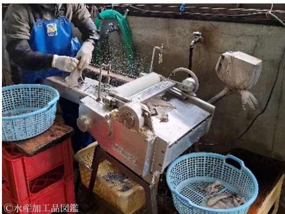
写真4 剥皮機で皮を剥く様子 (提供：長崎県)
