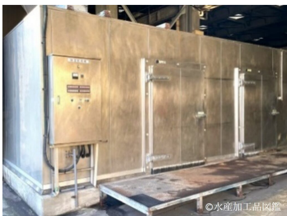
写真5 遠赤外線照射乾燥機 (提供：㈱ヤマニンベン)
