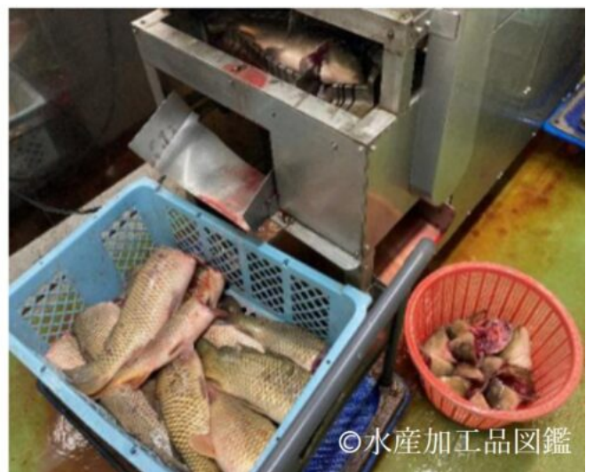
写真6 専用機器（頭部カッター）による頭部除去（左：投入前、右：投入後）（提供：山形県内水面水産研究所）
