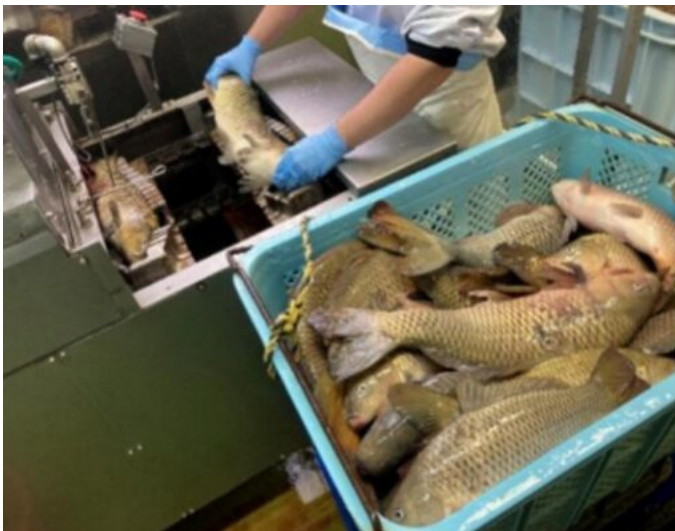
写真6 専用機器（頭部カッター）による頭部除去（左：投入前、右：投入後）（提供：山形県内水面水産研究所）
