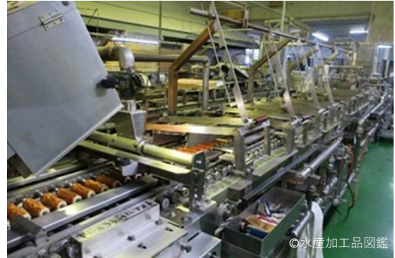
写真12 専用焼き機による焙焼4 (提供：(有) 谷ちくわ商店)
