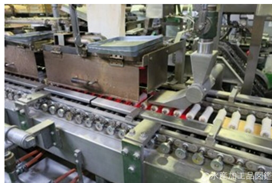
写真10 専用焼き機による焙焼2 (提供：(有) 谷ちくわ商店)
