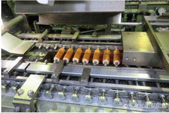
写真11 専用焼き機による焙焼3 (提供：(有) 谷ちくわ商店)
