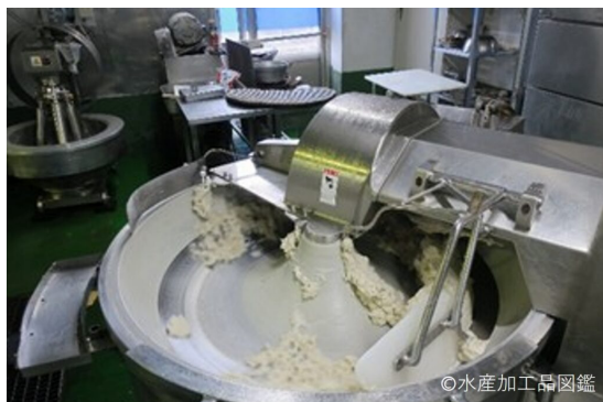
写真5 サイレントカッターによる播潰 (提供：(有) 谷ちくわ商店)
