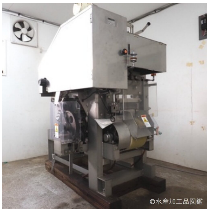
写真4 するめと昆布を細切りにする裁断機 (提供：北海道立工業技術センター)
