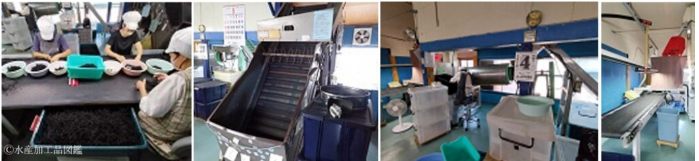
写真6 乾燥ヒジキの選別 （左より①目視による選別、②風力選別機（投入口）、③風力選別機、④色彩選別機（提供：長崎県総合水産試験場）
