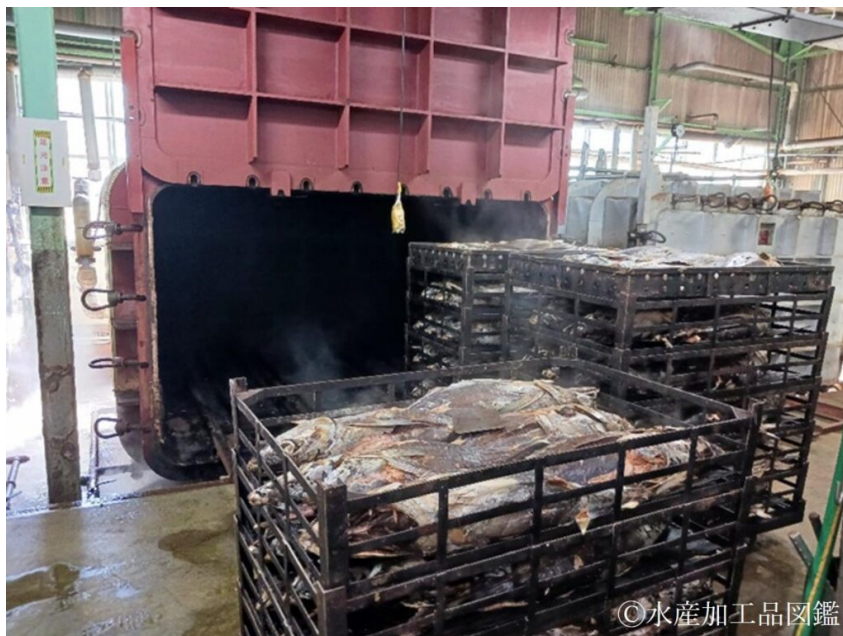
写真2 カツオ缶詰製造の蒸煮工程 （提供：㈱マルハチ村松）
