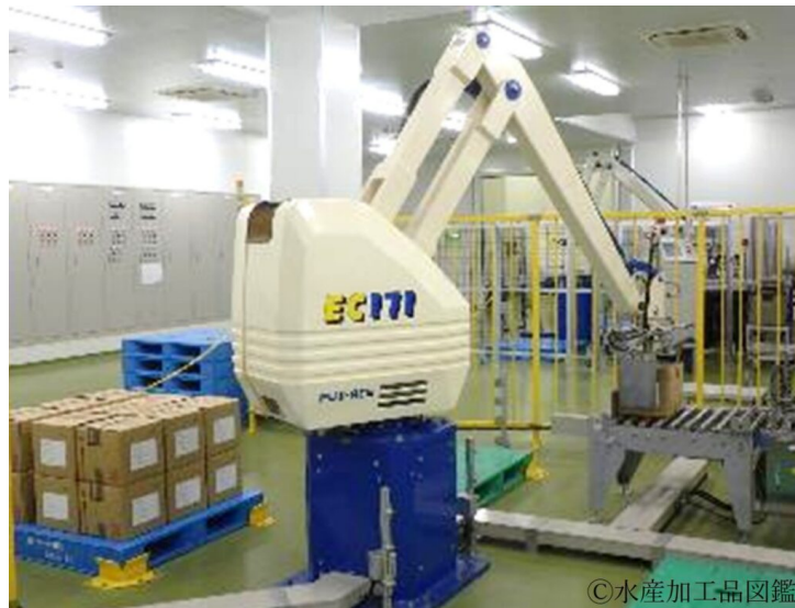
写真7 バッグインボックス充填梱包機 (提供：(株)マルハチ村松)
