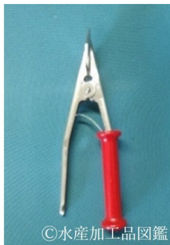
写真2 ウニの殻割（右は殻割器のパックリ）（提供：雄島漁協）
