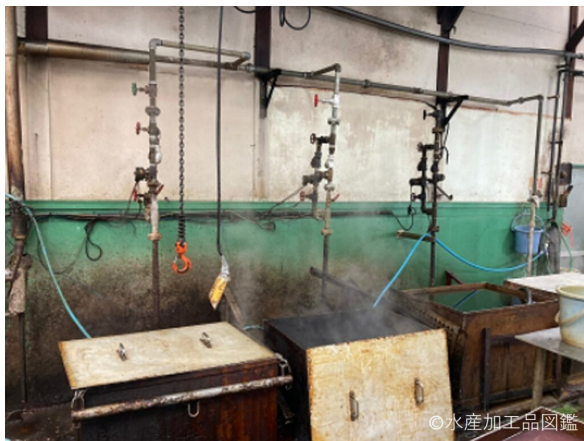
写真2 煮釜 (撮影：静岡県水産・海洋技術研究所)
