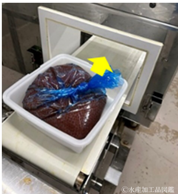
写真16 金属探知機検査 (佐藤水産(株)提供)
