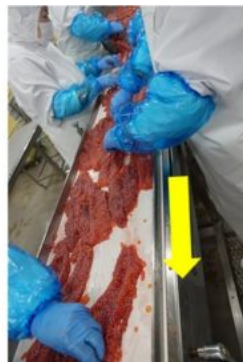
写真8 生筋子を写真の手前から奥の卵粒分離機へ送り (左)、筋子の卵膜が裂けた方を下にして広げ (中)、卵粒分離機のローラー部へ投入する (右)
