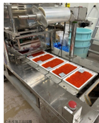
写真21 脱酸素剤封入、包装機でトップシール （佐藤水産(株)提供）
