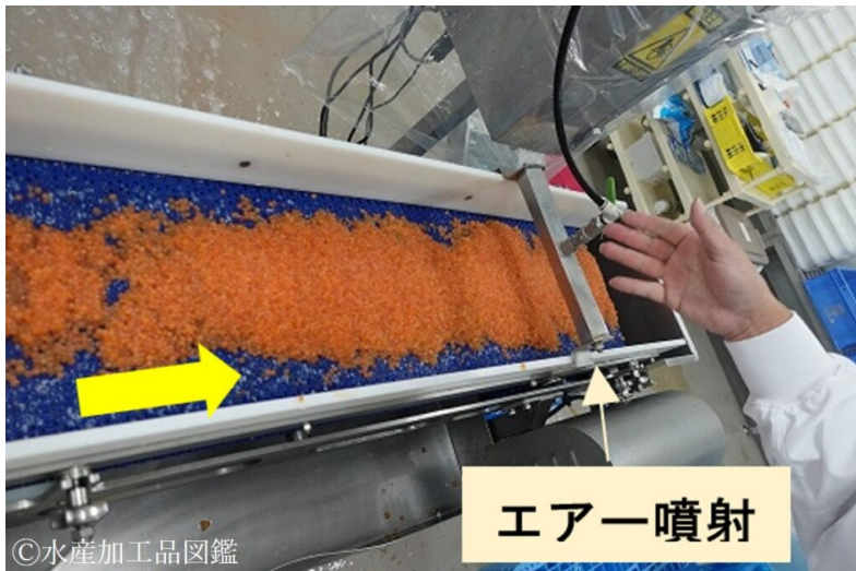
写真11 水切りの効率アップのエア一噴射（佐藤水産(株)提供）
