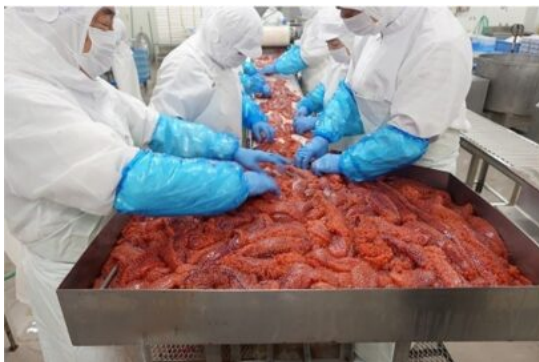
写真8 生筋子を写真の手前から奥の卵粒分離機へ送り (左)、筋子の卵膜が裂けた方を下にして広げ (中)、卵粒分離機のローラー部へ投入する (右)
