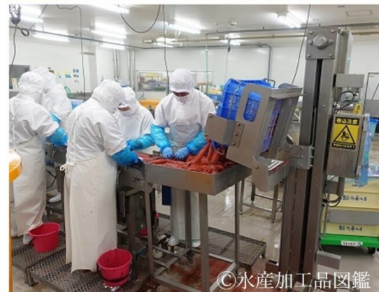
写真7 半自動機械で作業台へ (佐藤水産(株)提供)
