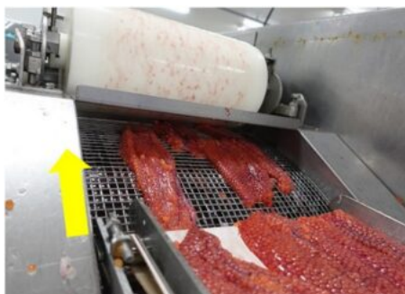
写真9 生筋子をローラーで金網部に押し当て卵粒を分離 (左)、卵膜は卵粒分離機の網上に残る (中)、分離された卵粒は洗浄工程へ送る (右) (佐藤水産(株)提供)
