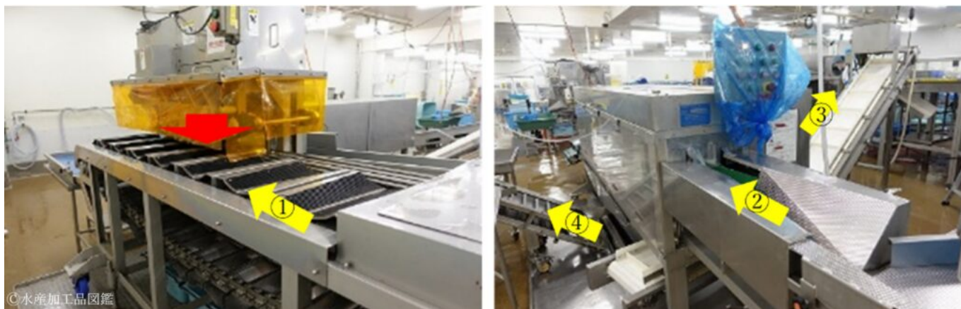
写真3 頭部（左）および内臓除去（右）処理機（佐藤水産(株)提供）
