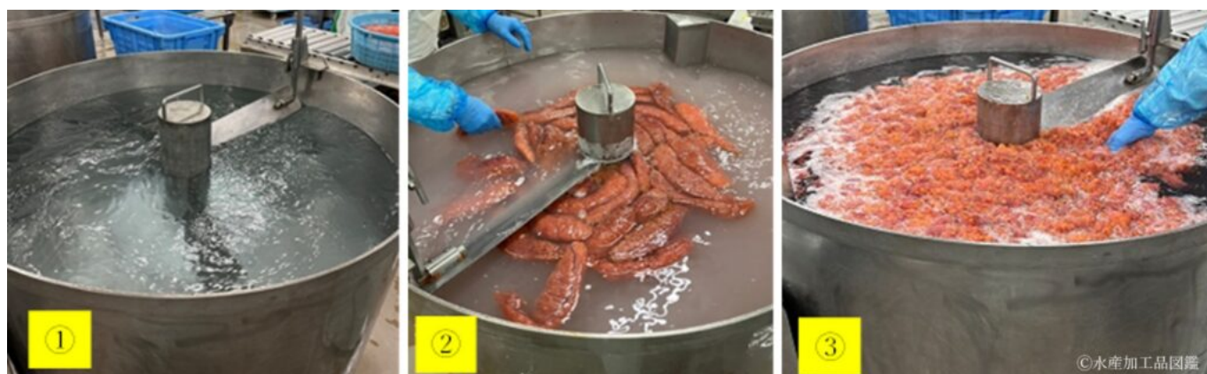
写真6 飽和塩水漬け工程（筋子／一口筋子）（佐藤水産(株)提供）
