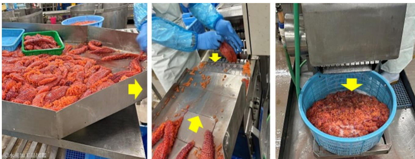
写真5 筋子細断専用機による筋子の裁断（左：細断前、中：細断機に投入、右：細断後）（佐藤水産(株)提供）
