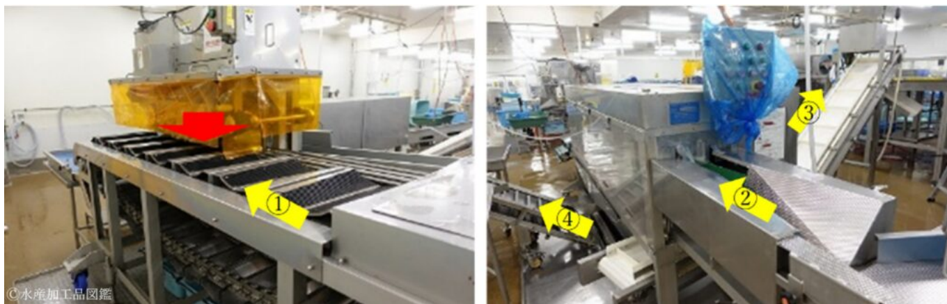
写真3 頭部（左）および内臓除去（右）処理機（佐藤水産(株)提供）①上部からカッター（赤矢印）が降りて頭部を切断②頭部切断後、内臓除去処理機で内臓③と魚体④に分別回収
