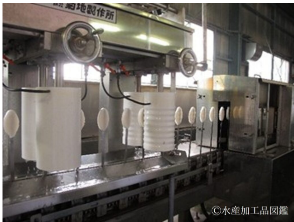
写真1 笹かまぼこ製造工程-1 (肉糊を金串につけて成形し、焙焼工程へ) (撮影：岡崎恵美子)
