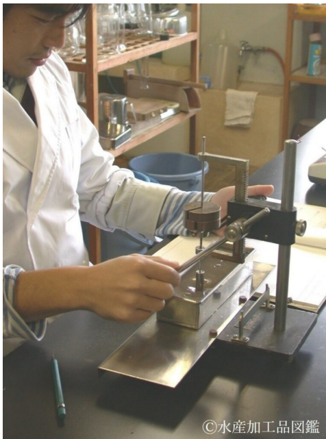
写真11 ゼリー強度試験 （提供：岐阜県食品科学研究所）
