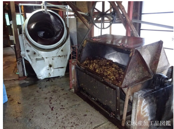
写真2 洗浄（揉捻機とドラム型洗浄機） (取材協力：山一寒天産業株式会社)
