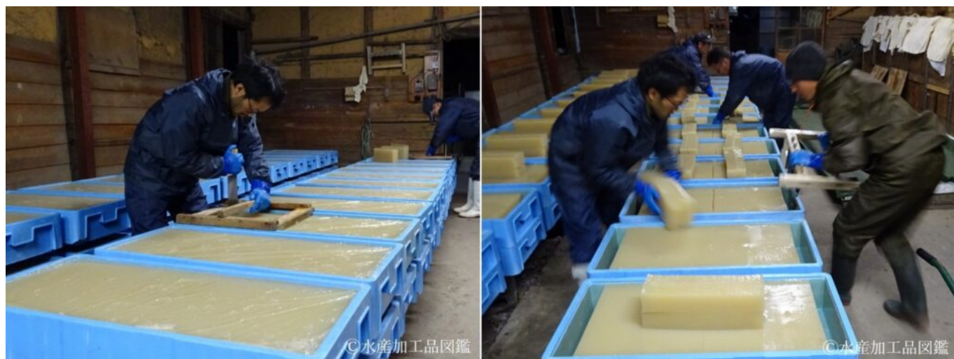
写真6 截 た ち (取材協力：山一寒天産業株式会社) (左：天切り包丁 (横に切り分ける)、右： マンガ (木杵製、縦に切り分ける))
