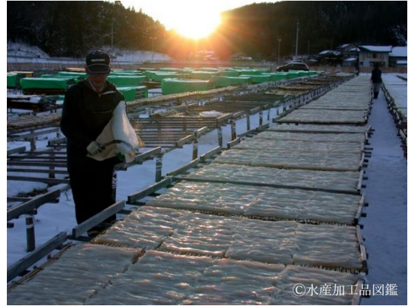
写真8 凍て取り (提供：岐阜県寒天水産工業組合)
