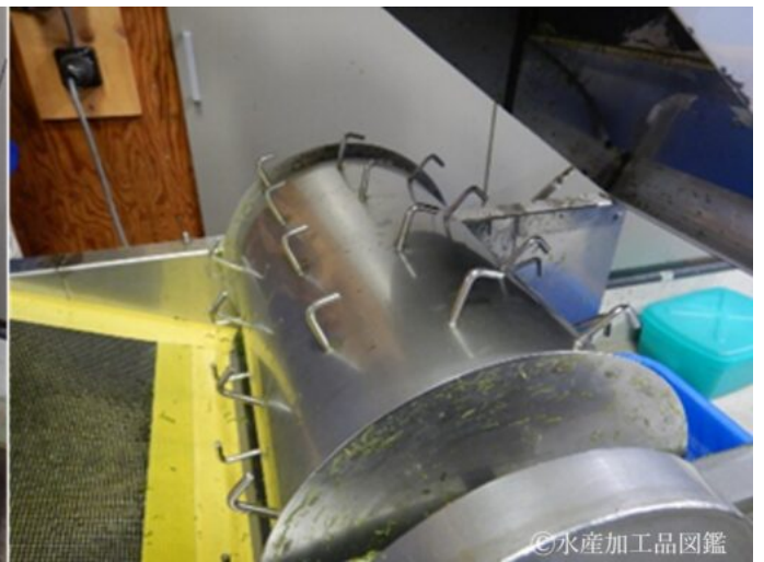
写真7 脱水して固まったあおさをほぐすサバキ機（左）とその内部（右） (撮影：三重県水産研究所)
