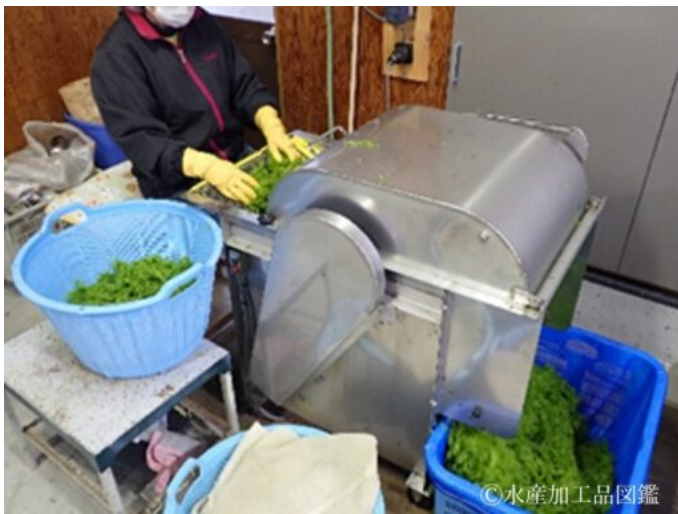
写真7 脱水して固まったあおさをほぐすサバキ機（左）とその内部（右） (撮影：三重県水産研究所)
