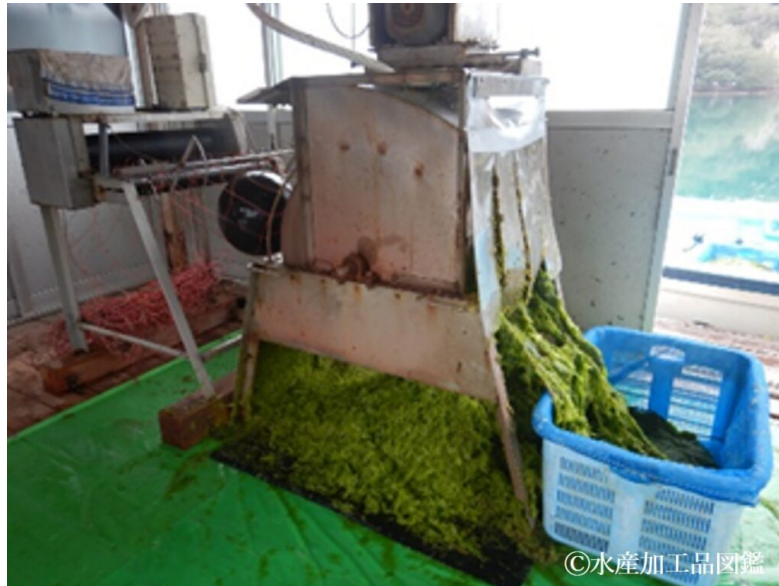
写真3 養殖網をたたき機に通して網からあおさを取り外す (撮影：三重県水産研究所)
