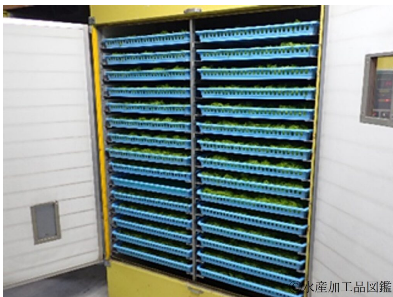
写真9 乾燥機を用いた乾燥 (撮影：三重県水産研究所)
