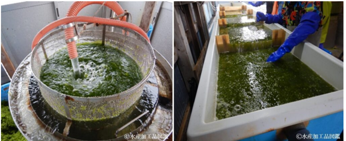
写真4 のり洗い機（左）や水流式選別機（右）によるあおさの洗浄 (撮影：三重県水産研究所)
