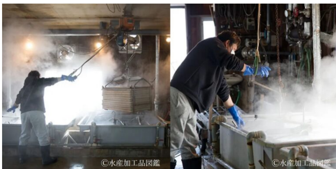
写真3 角釜での煮熟作業 (提供：中原水産有限会社)
