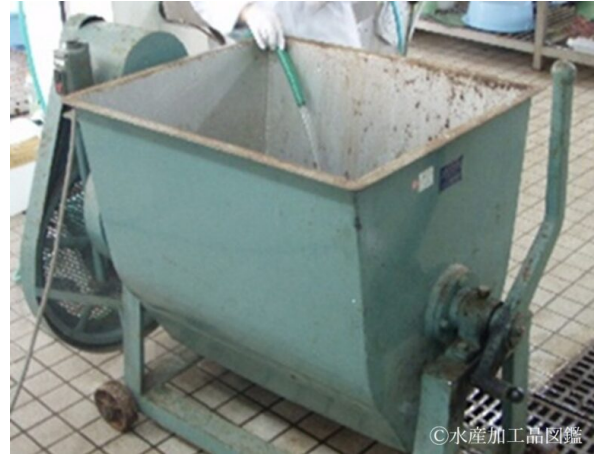
写真2 横型の魚洗機 (島根県水産技術センター)
