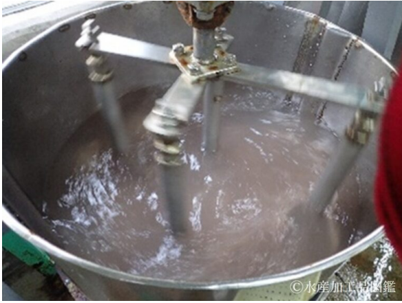
写真1 縦型の魚洗機 ((有)あけぼの丸FACTORY)
